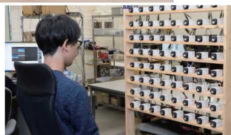
スピーカーアレイ(全盲の人に視覚に代わって音で物の動きを伝える“感覚代行”システム)
