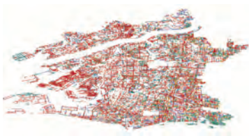
都市全体の下水道管の劣化予測シミュレーション (2050年度)
