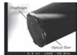
極細径光ファイバ圧力センサ(外径125μm) Ultra-miniature fiber-optic pressure sensor (O.D. 125μm)
