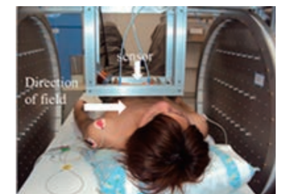
室温動作の生体磁気情報計測システムによる心磁界測定実験 Measurement of Magneto Cardiogram without magnetic shielding
