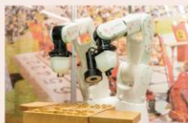
電王手板将の展示ブース。2本のアームの連携により駒を運送するなどの繊細な動作を実現。
