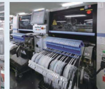
基板組立ライン Circuit-board assembly
