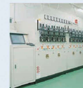
電力量計自主検査装置 Electricity meter inspection test equipment
