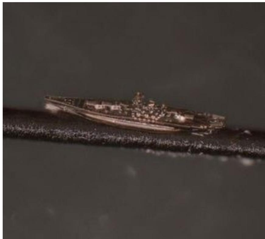
積層2光子重合の3D造形技術とサブミクロンの分解能を持つIP樹脂を用いることで、従来の製法では不可能な形状や精度の製品を製造することが可能です。今後、メカトロニクス、バイオテクノロジー、マイクロエレクトロニクス、光学、医療、材料工学などの研究・産学分野での活用が期待されます。
