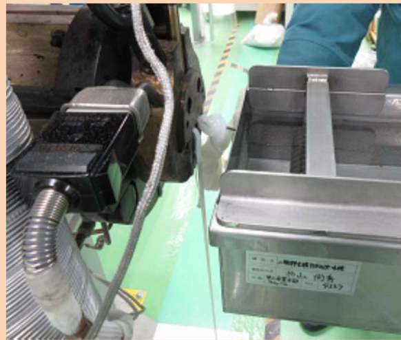
右:コンパウンド材の温度測定
