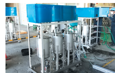
廃食油発電システム 装置試運転風景 The commissioning of the waste cooking oil power generation system
