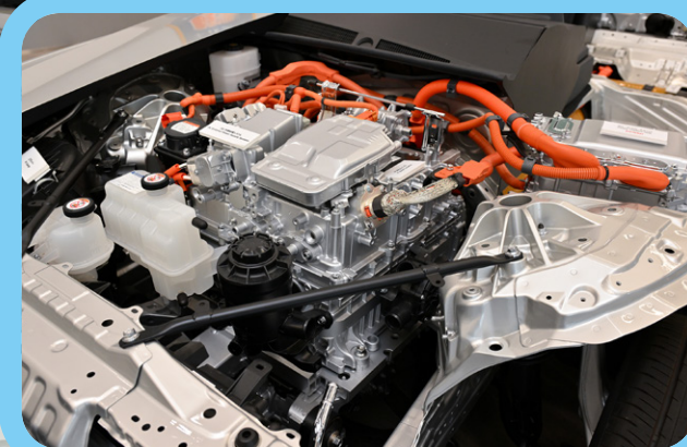
高出力かつ小型化を実現した2代目 MIRAI 搭載の燃料電池
