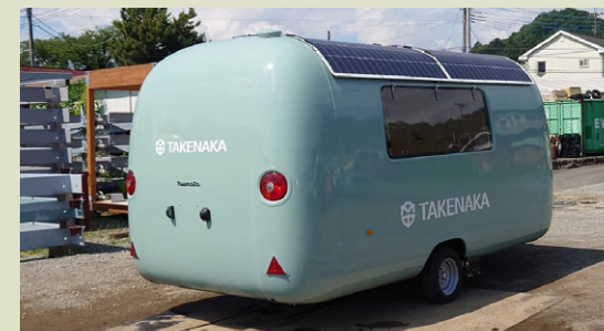
オフグリッド型モバイルハウス。電気・通信インフラの整っていない場所でも、ソーラーパネル・蓄電池・制御装置による自立電源システムと、衛星インターネット（スターリンク）により自立稼働が可能
