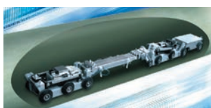
管路調査・劣化診断
