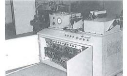
掃除機ローター整流子圧入自動機
