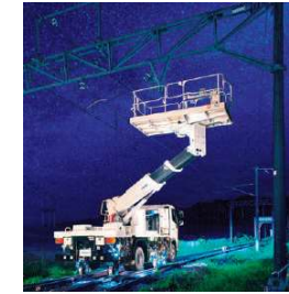
ジャッキ未接地の状態でも従来機プラス1.2mの作業範囲を実現
