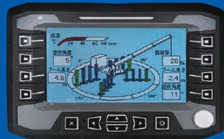
さまざまな情報を操作席の液晶画面に表示する「マルチモニター」
