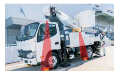
輪止めが正しく設置されているかを検出し、適切な位置に輪止めが無い場合にはジャッキ作動を停止します。
