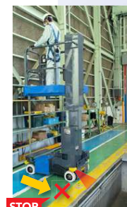
危険な段差を検知した際に車両を自動停止します。
