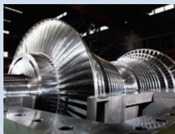
蒸気タービン
