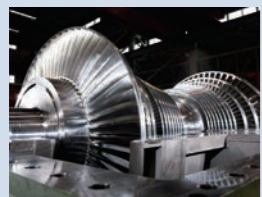
蒸気タービン
