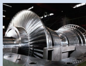
蒸気タービン
