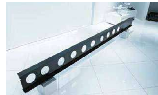
炭素繊維「テナックス」を使用した航空機の構造材
