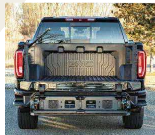
荷台部分に熱可塑性炭素繊維複合材料「Sereebo」が使用された ゼネラルモーターズ社製ピックアップトラック
