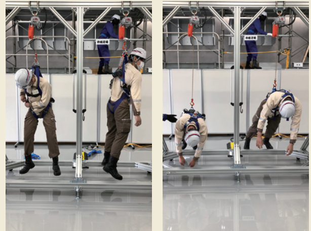
安全帯ぶら下がり体験（左はフルハーネス型、右は胴ベルト型）
