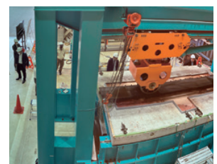
輪荷重走行試験 関係者立会
