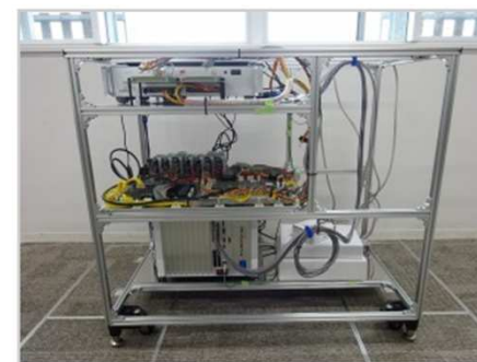
Typhoon HILとコントローラをラックに収納
