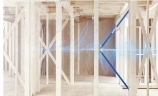
実大振動実験では熊本地震前震（震度7相当）を1回、本震（震度7相当）を6回加えても倒壊しないことを実証。
