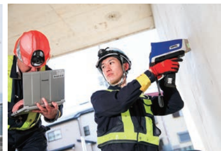
非破壊検査機器を用いた構造物の点検
