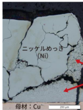
A-A' 断面 (黄線部) ニッケルめっき組織
